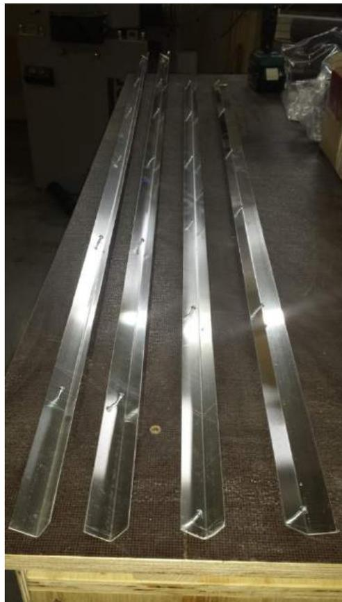
**9c)** Falten Sie die Dachabdeckung auf eine der Seiten einmal um das Dach herum. Nehmen Sie eine der beiden vorbereiteten längeren 90 Grad Aluleisten. Schrauben Sie diese durch die Dachabdeckung von unten auf die Dachplatten. Die Aluleisten sollten bündig mit der Außenkante des Daches sein, sowie hinten und vorne bündig abschließen.
